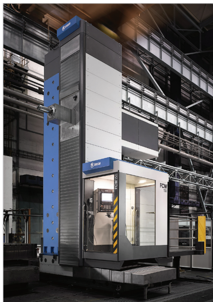
Horizontální frézovací a vyvrtávací stroj Škoda FCW150, výrobce: Škoda Machine Tool, ocenění: Red Dot Winner 2015. (Foto: Filip Šlapal)
